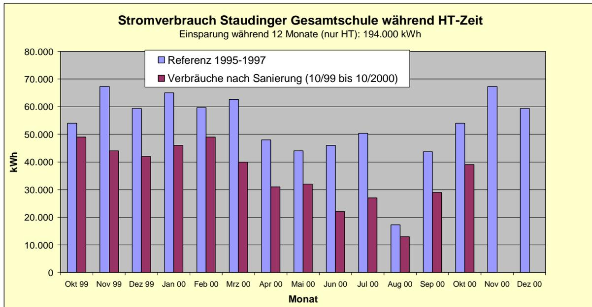
Die maximale Bezugsleistung von den Stadtwerken konnte um über 100 Kilowatt reduziert werden. Dieses gute Ergebnis konnte zum einen durch die Effizienzsteigerung bei der Beleuchtung sowie durch die Installation und Optimierung der neuen Lastmanagementanlage erzielt werden.
